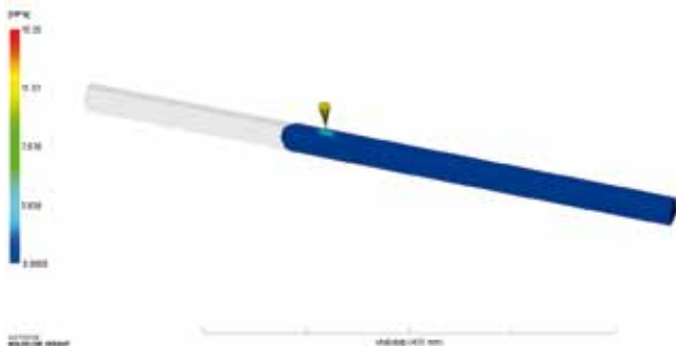
Simulation der Einspritzphase für die geplante Prüfkörpergeometrie in Moldflow Insight, Autodesk Inc.
