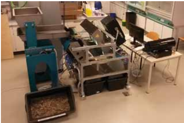
Kunststoffanalysator zur quantitativen Bestimmung von Kunststoffen aus heterogenen Schüttgütern (Abfällen)
